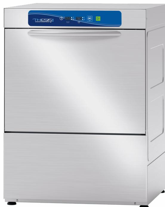
Модели линии **STEEL** оснащены автоматическим умягчителем, который эффективно справляется с образованием известкового налёта. Смягчитель полностью автономен и автоматически регулирует свои интервалы регенерации в зависимости от жёсткости воды на входе; вам необходимо только заполнять солевой бак каждый раз, когда на дисплее появляется сообщение «Нет соли». Регенерация смол происходит во время циклов мытья, поэтому останавливать машину не требуется.
